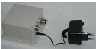
Steuerbox (125x120x 60) mit Steckernetzteil, bzw. Batteriefach für 4 x AA 1,5V Batterien
