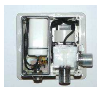
Box geöffnet Batteriefach, Magnetventil, PCB Montageposition wie in Zeichnung
